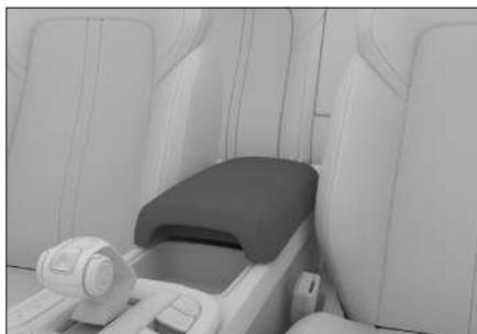
3. Вставьте обернутую тканью плоскую отвертку в прорезь квадратной пластины, подденьте ее, чтобы найти тросик разблокировки положения Р селектора КПП.
