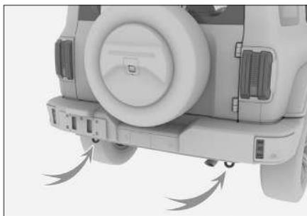
Задний буксировочный крюк расположен по обеим сторонам задней части ходовой.
