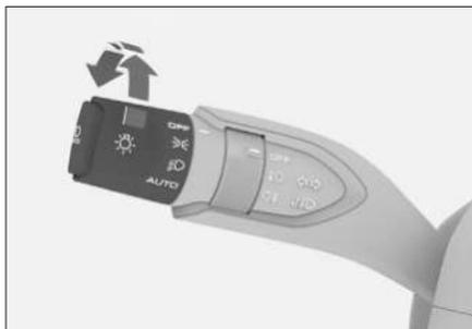
Поверните главный переключатель освещения в положение ☀ подфарника, включите габаритные огни и подсветку номерного знака.
